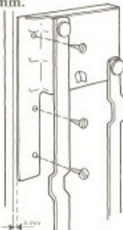
Schrauben Sie die Beschläge an beiden Innen- seiten des Schranks fest!
